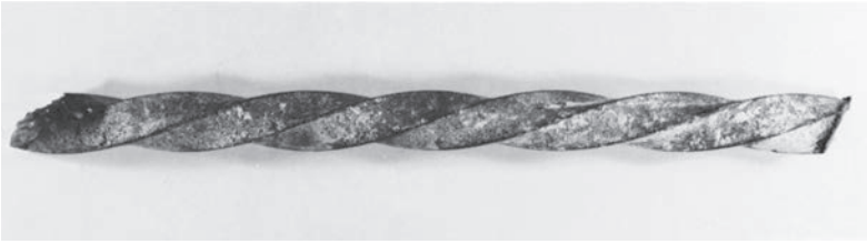
La varilla cuadrada y torcida, anteriormente usada para aumentar la adherencia entre el concreto y el acero. (Cortesía de Clemson University Communications Center.)
